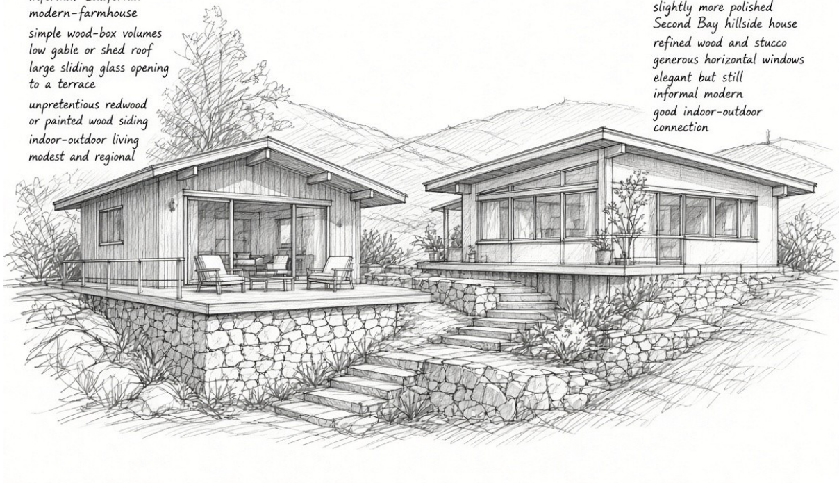
Figure 12: La «Second Bay Tradition», al estilo de Wurster y Dailey. Las anotaciones son del propio dibujante. Ambos edificios tienen una estructura de madera y un estilo informal, y se abren a una terraza en lugar de presentar una fachada, siendo el de Dailey el más pulido de los dos.
