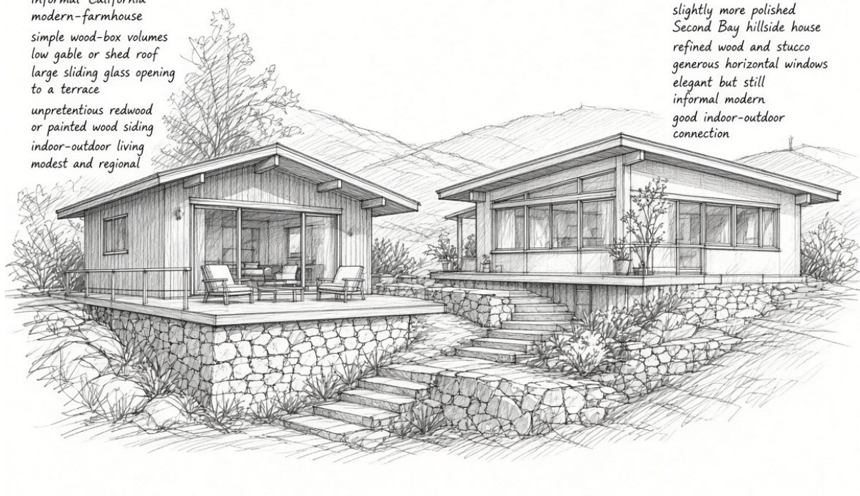
Figure 12: La tradition « Second Bay », dans le style de Wurster et Dailey. Les annotations sont celles du dessinateur lui-même. Les deux bâtiments sont construits en bois et présentent un style informel ; ils s'ouvrent sur une terrasse plutôt que de présenter une façade, celui de Dailey étant le plus soigné des deux.
